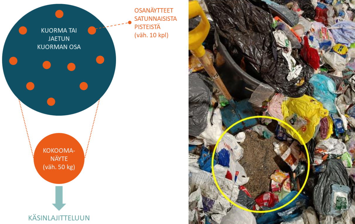
Kuva 4. Havainnekuva näytteenoton toteutusperiaatteesta sekä satunnaisesta kuorman pisteestä, josta on kerätty osanäyte
